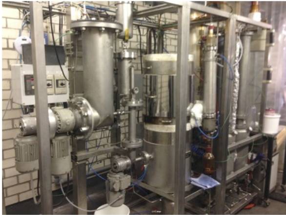
Figuur 3: Installatie waarin vast organisch afval door middel van pyrolyse in olie kan worden omgezet. De verkregen olie kan afhankelijk van de samenstelling worden ingezet als brand- of grondstof.
