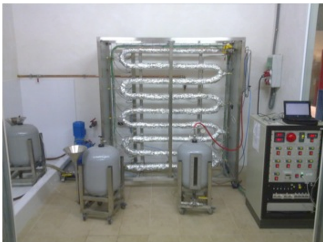
Figuur 2: Installatie waarin sterk vervuild water en organische afvalstoffen bij hoge druk kunnen worden omgezet in olie (Hydro Thermal Upgrading) of superkritisch kunnen worden vergast.
